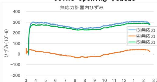
図-5 無応力計器内ひずみの経時変化図
